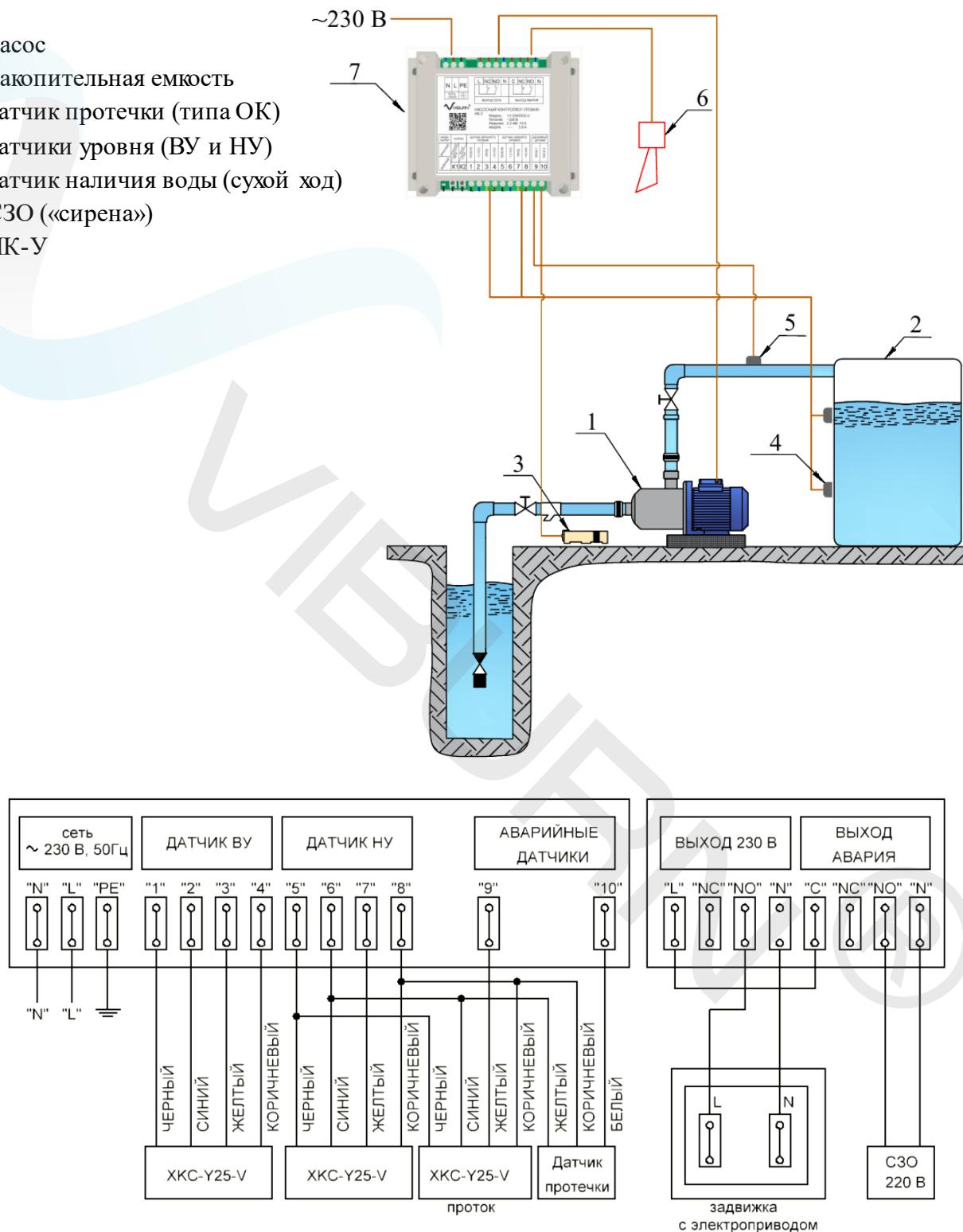
Рисунок 6.6 – Наполнение накопительной емкости из открытого водоема (2)
