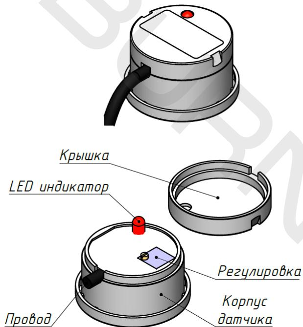
Рисунок 4.2 – Регулировка чувствительности датчика уровня
