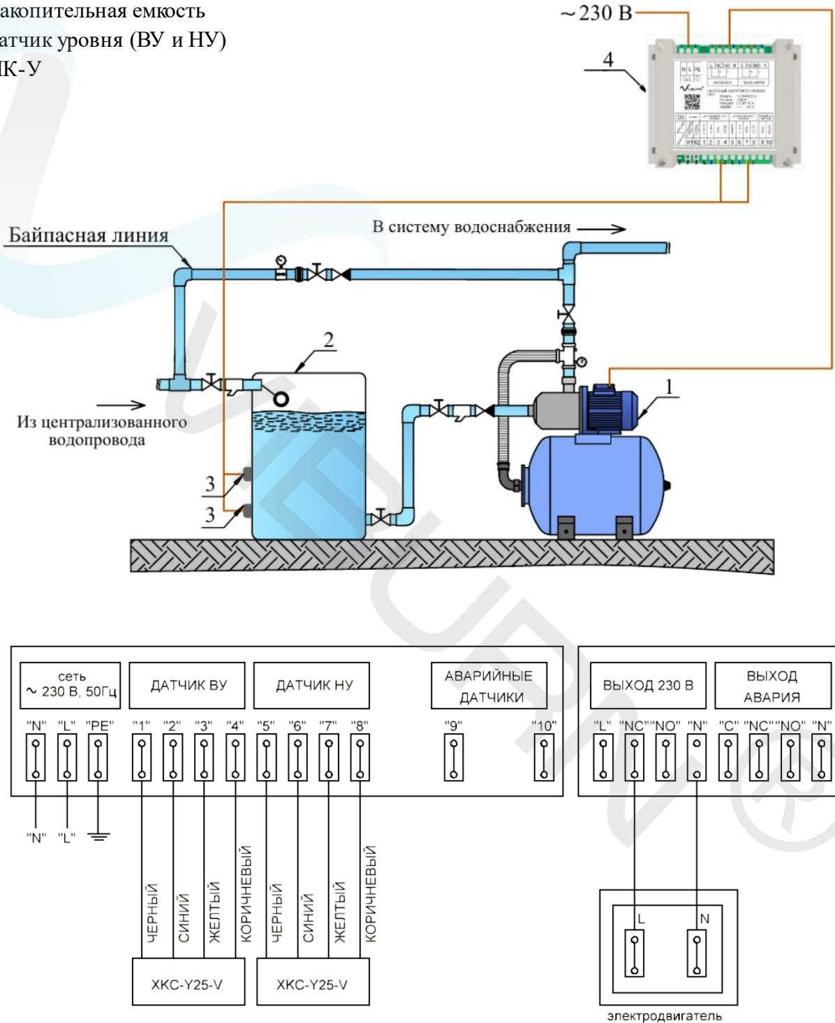
Рисунок 6.3 – Водоснабжение здания из центрального водопровода
