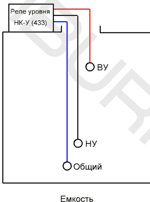
Рисунок 4.2 – Монтаж кондуктометрических датчиков уровня
