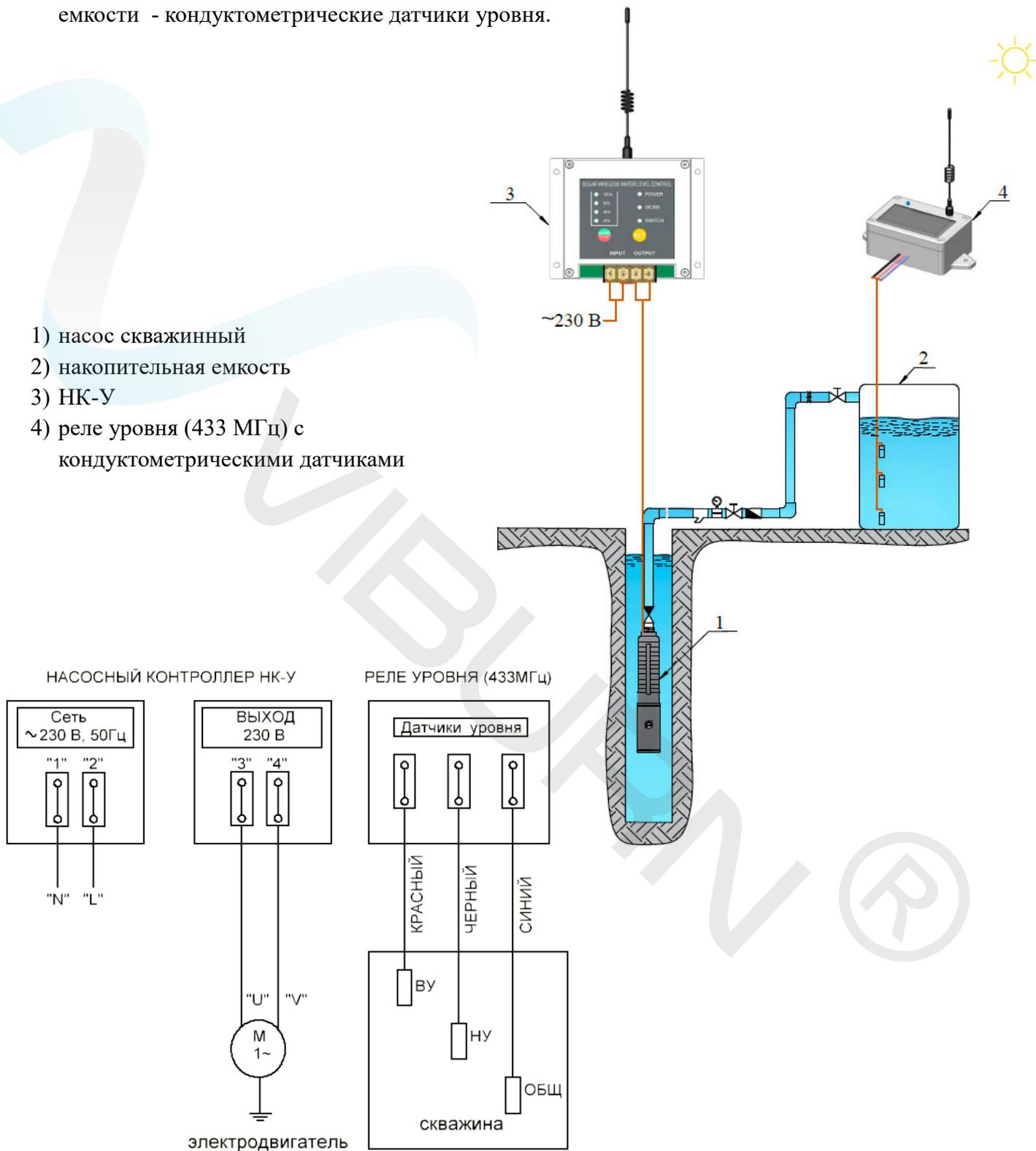
Рисунок 6.1 – Наполнение накопительной емкости из скважины
